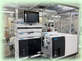
PFAS関連分析装置 LC/MS/MS アジレントテクノロジー社製 6475型
